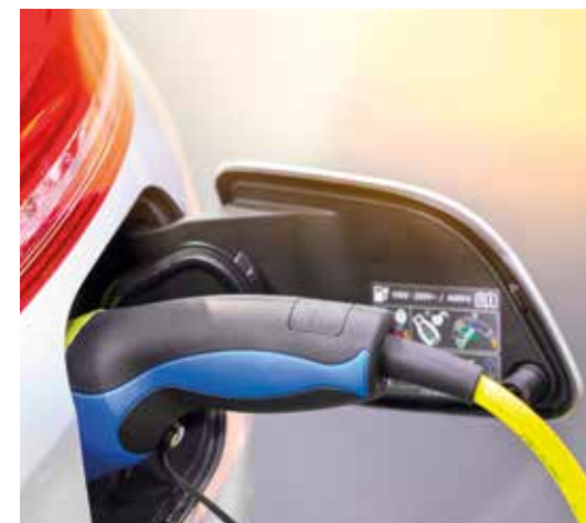
Punto de carga para vehículos eléctricos.
